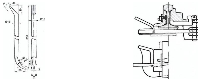
Rys. 20. Badanie prawidłowości przylegania haka do opórki przy użyciu drążka stalowego a) drążek stalowy, b) miejsce wkładania haka między hak a opórkę.
